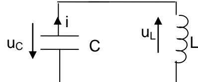
$$\mathbf{b-} \text{La solution de l'équation différentielle précédente est : } u_L(t) = U_{Lm} \sin(\omega_0 t + \phi_{u_L}) \Rightarrow \frac{d^2 u_L}{dt^2} = -\omega_0^2 \cdot u_L$$
