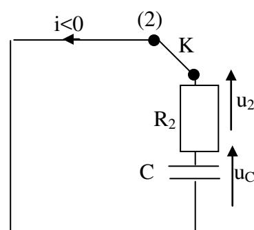
2- A l'instant  $t_2$ , l'énergie emmagasinée par le condensateur  $0,14 E_{C0} \Rightarrow$
