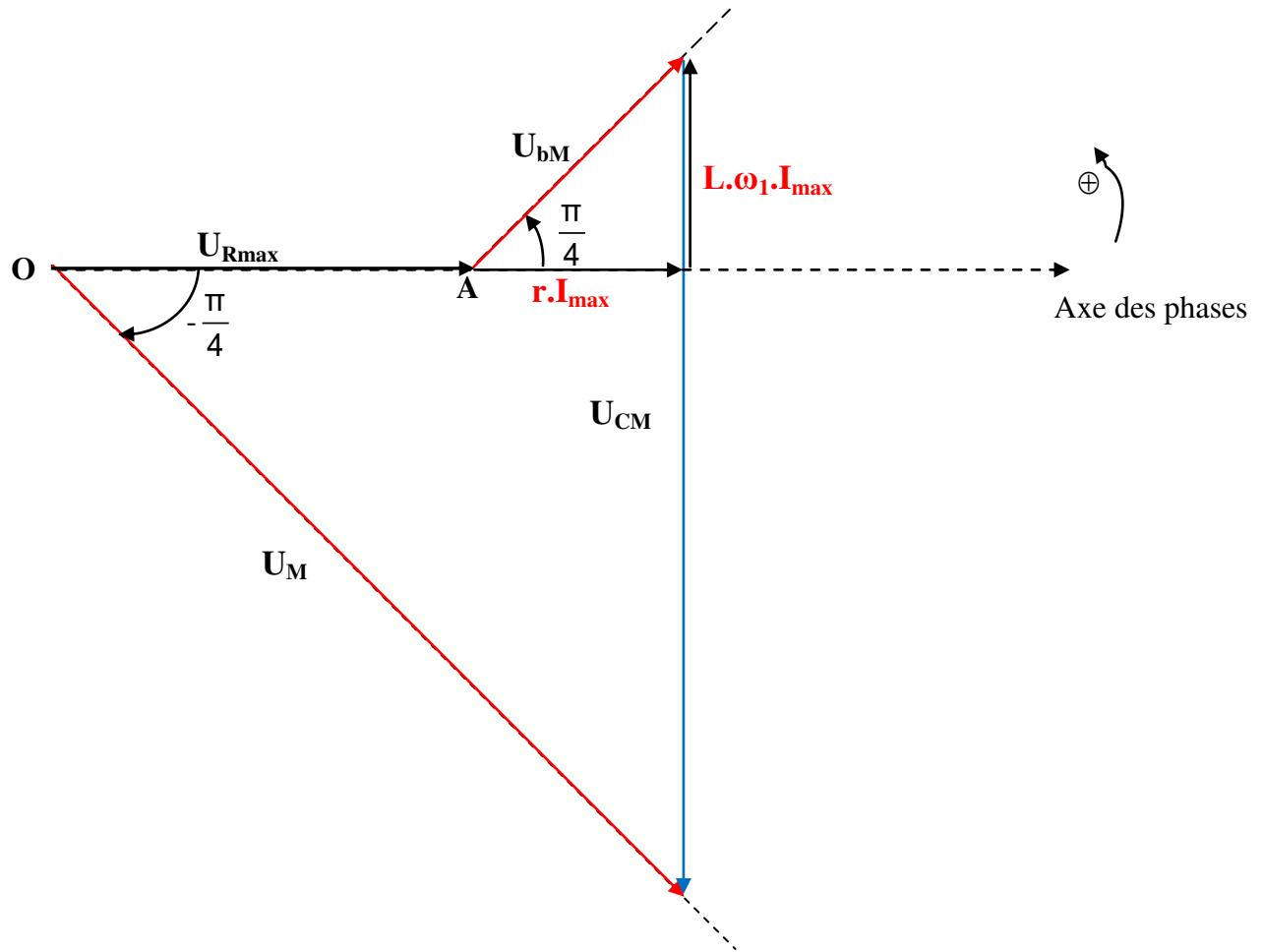
b- On a  $U_{Rmax} \longrightarrow 5,7 \text{ cm} \Rightarrow U_{Rmax} = 5,7 \text{ V} = R_0 \cdot I_{max} = R_0 \cdot I_1 \sqrt{2} \Rightarrow R_0 = \frac{U_{Rmax}}{I_1 \sqrt{2}} = \frac{5,7}{0,1 \cdot \sqrt{2}} \approx 40 \Omega$
